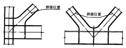
图 8.2.6 支撑端部刚接构造示意图
