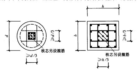
图 6.3.7 芯柱尺寸示意图
