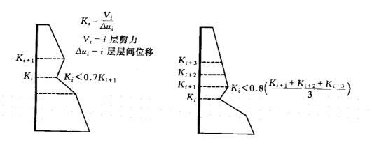
图 3.4.2-4 沿竖向的侧向刚度不规则(有柔软层)
