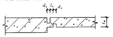
缝宽 d。大于 5mm; 两缝间距 l。大于 50mm。 图 6.7.2 外筒裙墙受剪控制缝构造
