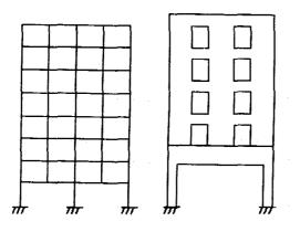
图 3.4.2-5 竖向抗侧力 构件不连续示例
