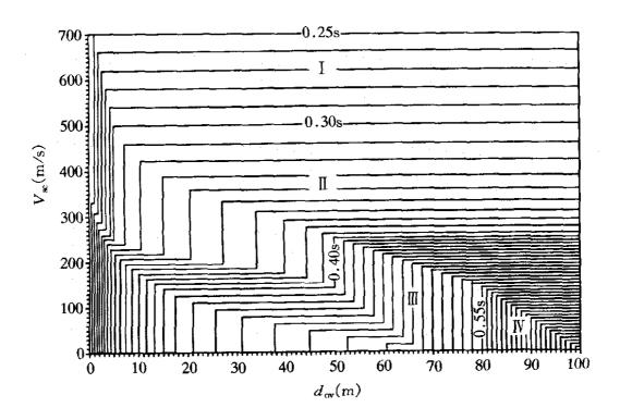
图 4.1.6 在  $d_{ov}$ - $V_{se}$ 平面上的  $T_{g}$  等值线图 (用于设计特征周期—区,图中相邻  $T_{g}$  等值线的差值均为 0.01s)
