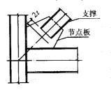
图 8.4.3 支撑端部节 点板构造示意图
