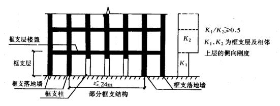
图 6.1.9 框支结构示意图
