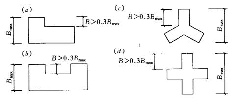
图 3.4.2-2 建筑结构平面的凹角或凸角不规则示例
