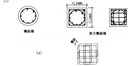
图 6.3.12 各类箍筋示意图
