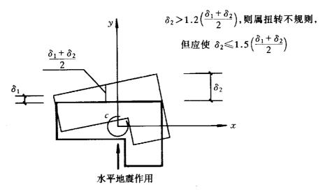
图 3.4.2-1 建筑结构平面的扭转不规则示例
