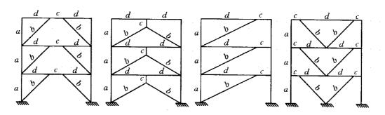
图 8.1.6 偏心支撑示意图 (a一柱;b一支撑;c一消能梁段;d一其他梁段)
